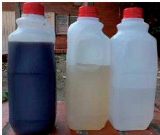
**Figura 8.** Muestras de lixiviado en diferentes puntos del prototipo variando el ángulo de inclinación.
